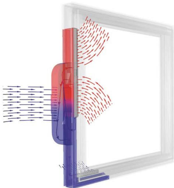
Energieeffizienz wird großgeschrieben: Dafür sorgt ein integrierter Wärmetauscher mit einem Wärmerückgewinnungsgrad von 93 %. (Grafik: epr/Internorm)
