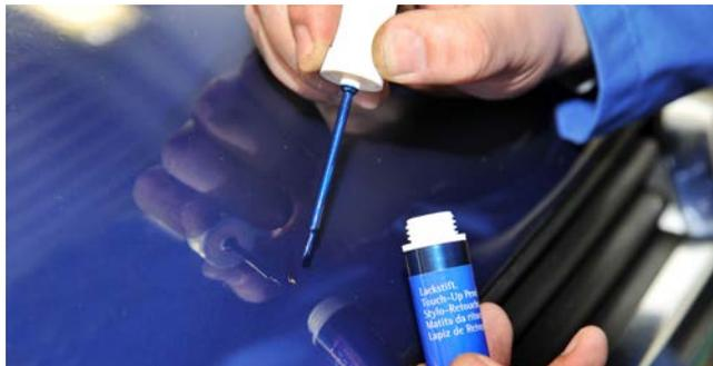
**Kleine Steinschläge im Lack lassen sich per Smart-Repair unsichtbar machen. Foto: djd/Kfzgewerbe**
