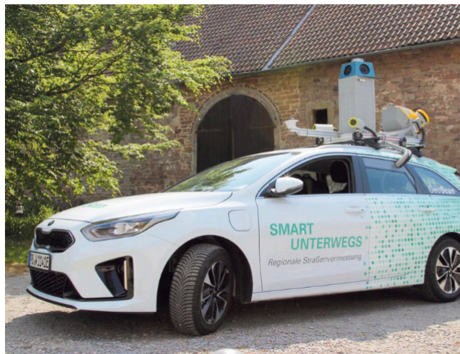
Das GeoScan-Fahrzeug von Westfalen Weser ist mit moderner Kamertechnik ausgestattet und erfasst Straßen sowie ihr Umfeld digital und dreidimensional (Foto: Westfalen Weser)
